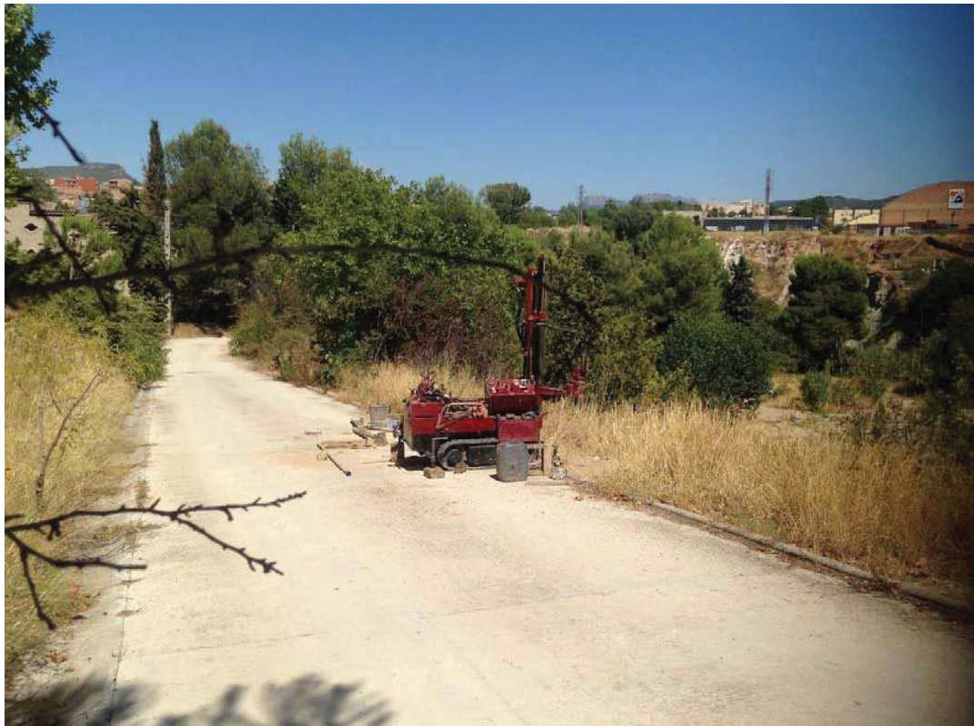
Fotografia de l'emplaçament de la sonda en el punt de sondeig S-1 amb una fondària de reconeixement assolida de 7,90 m.
