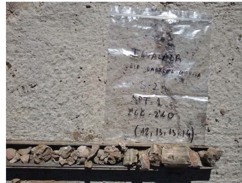
Fotografia del portatestimonis de l'assaig SPT-3 realitzat in situ en el sondeig S-2 a la fondària de 2,00 m a 2,60 m.
