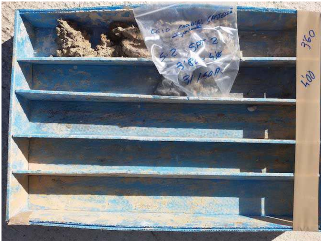
Fotografies de les caixes de recuperació del testimoni del sondeig S-2 de la fondària de 0 m a 3,00 m, i de 3 m a 4 m.
