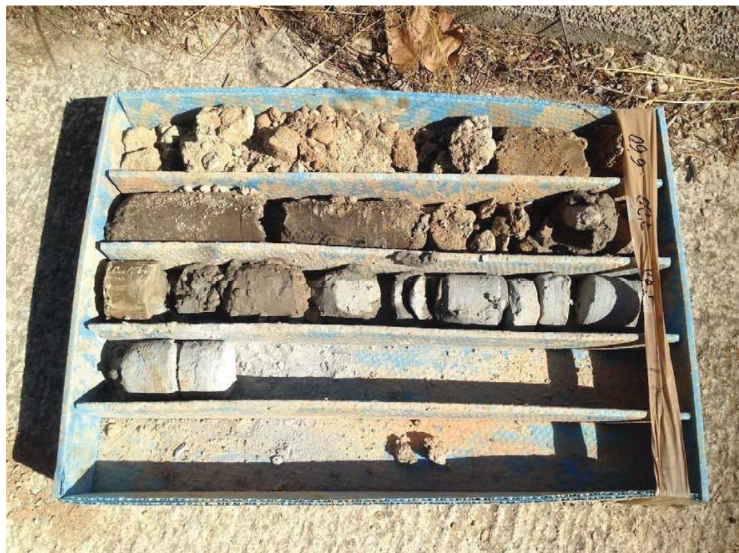
Fotografies de les caixes de recuperació del testimoni del sondeig S-1 de la fondària de 3 m a 6,00 m, i de 6 m a 7,90 m.
