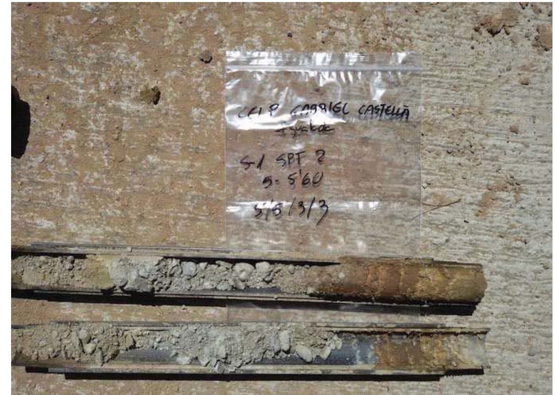
Fotografia del portatestimoni de l'assaig SPT-2 realitzat in situ en el sondeig S-1 a la fondària de 5,00 m a 5,60 m.
