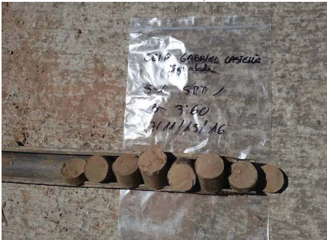
Fotografia de l'emplaçament del portatestimoni de l'assaig SPT-1 realitzat in situ en el sondeig S-1 a la fondària de 3,00 m a 3,60 m.
