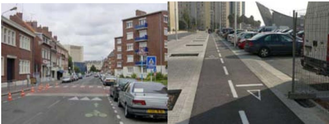
Figura 17: Exemples de carrer de zona 30 i via segregada en vorera: Vorera bici
