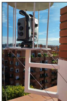
Instal·lació i lectura prismes en façanes. Teodolit de lectura automàtica per a prismes
