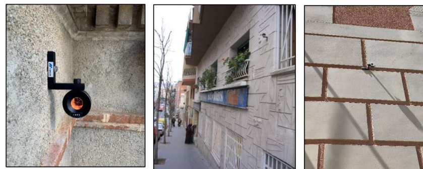
Instal·lació i lectura prismes en façanes. Teodolit de lectura automàtica per a prismes
