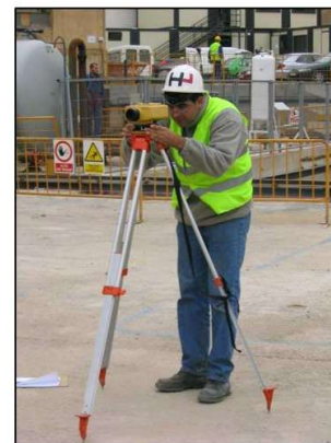
Instal·lació i lectura de fita d'anivellació de terreny en superfície
