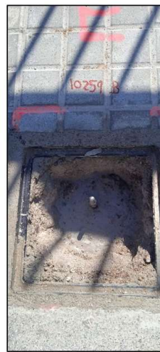
Instal·lació i lectura de fita d'anivellació de terreny en superfície
