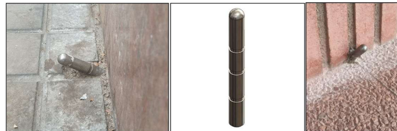
Instal·lació i lectura perns d'anivellació en façana
