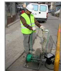
Perforació prèvia, instal·lació i lectura instrumentació profunda de terreny
