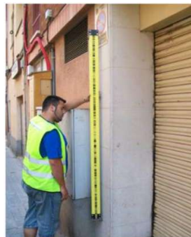
Instal·lació i lectura perns d'anivellació en façana
